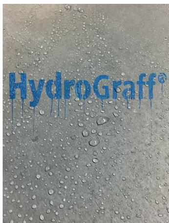
**Bild 2** Testfläche – HydroGraff – Produkte zeigen einen deutlichen Abperleffekt.
