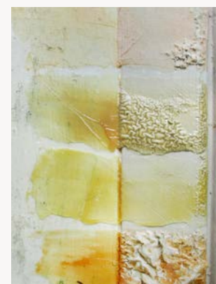
Mit Hilfe von Testflächen ermitteln Sie den optimalen Abbeizer für Ihr Objekt.
